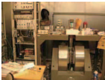
核磁気共鳴（NMR）実験装置。 電磁石と組み合わせてマイクロな磁性を探ります。
