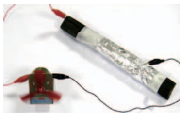
↑「備長炭電池」 備長炭とアルミホイルと食塩水があれば、 モーターが回ります。
