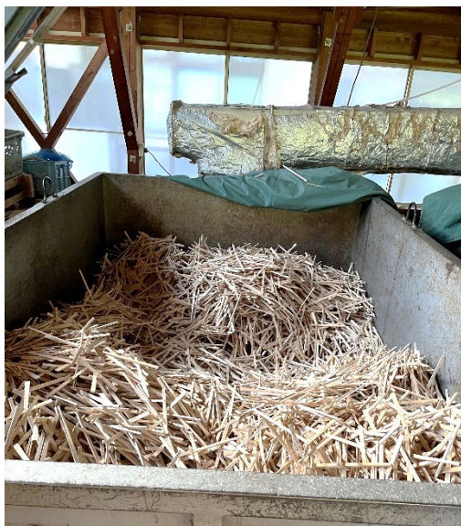
セルフ箸蔵でできた割り箸で約50度の部屋で乾燥させている。この後、仕分けが行われる。
