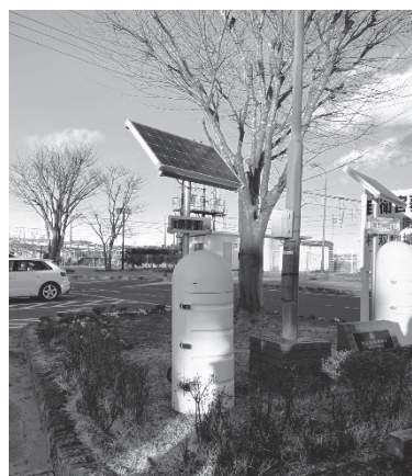
小高区に行った際に見かけた駅の前に置かれている放射線量を測る測定器
